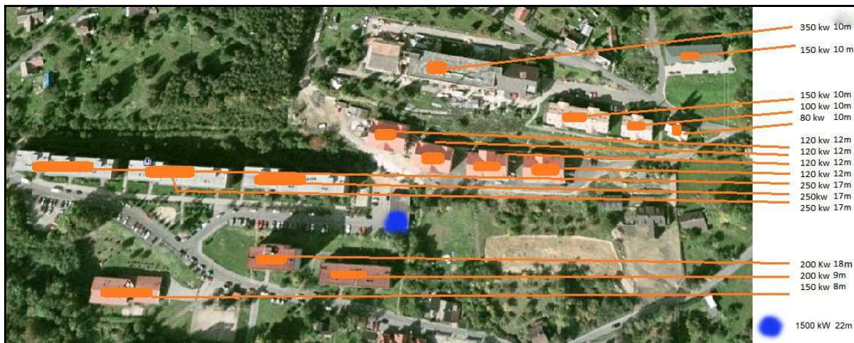
obrázek 2 – rozmístění kotlů, jejich výkon a výška komínů (varianta A) modrý puntík – umístění kotle, jeho výkon a výška komína (varianta B) Pozn.: ve variantě A přibudou 2 kotle na budově MÚ a další 2 na objektu DPS
